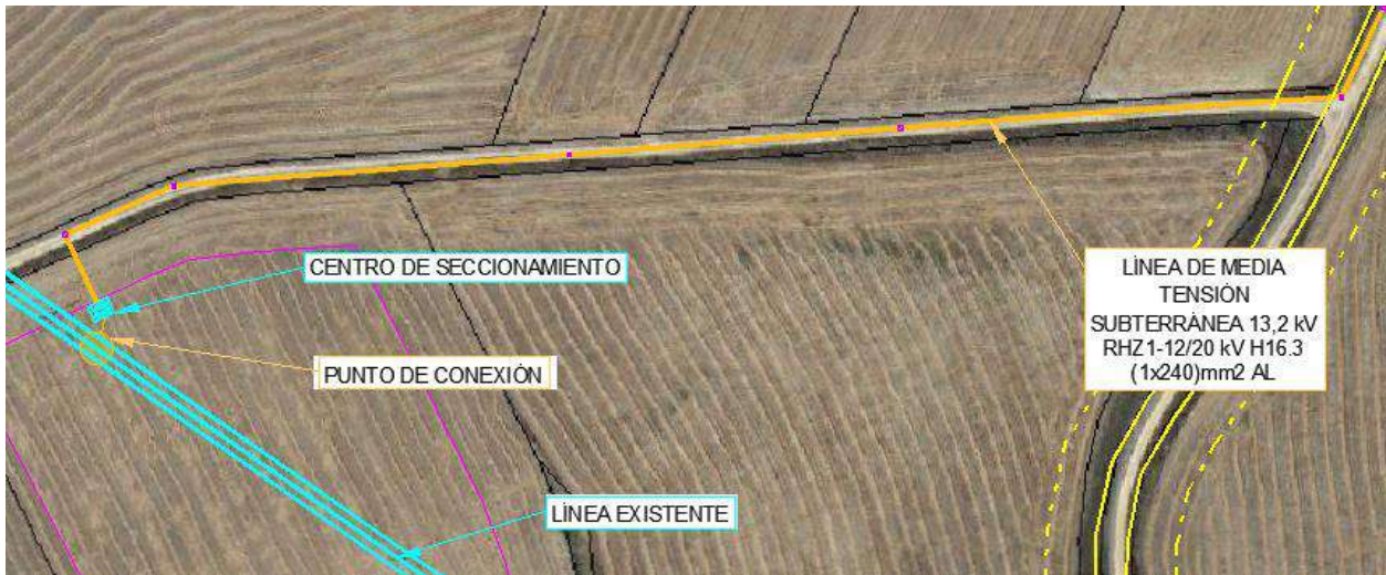
Ilustración 27. Línea de evacuación subterránea tramo II
